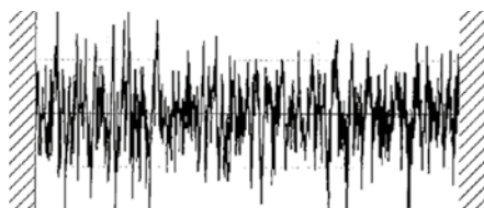
Yta efter slutslipning R_a = 0,223
